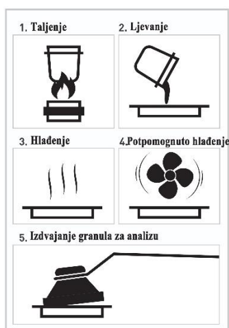
Slika 5. Postupak pripreve taljenih pastila za XRF analizu
