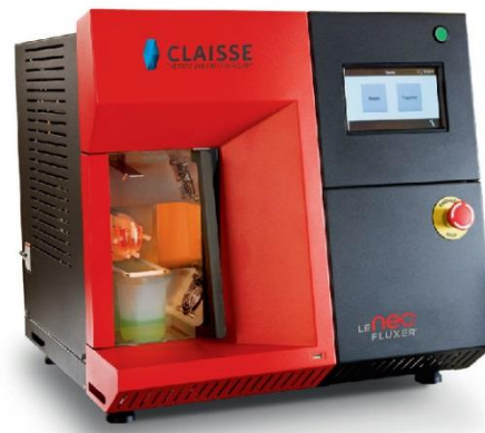
Slika 5. Postupak pripreve taljenih pastila za XRF analizu
