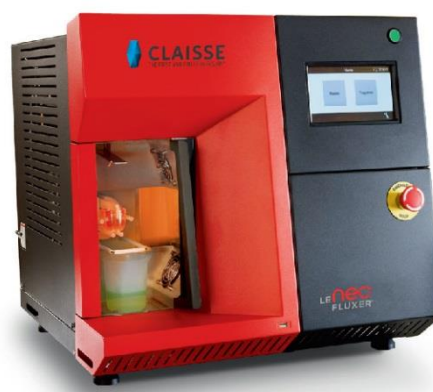
Slika 5. Postupak pripreve taljenih pastila za XRF analizu
