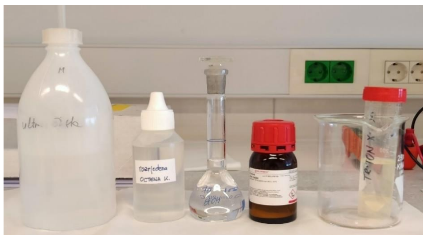
Slika 21. Kemikalije korištene za pripremu ZnO pasti
