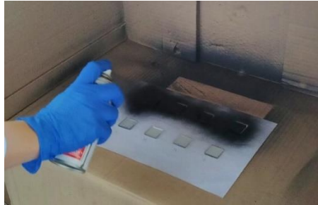
Slika 28. Nanošenje grafita na vodljivu stranu stakalaca sprej tehnikom
