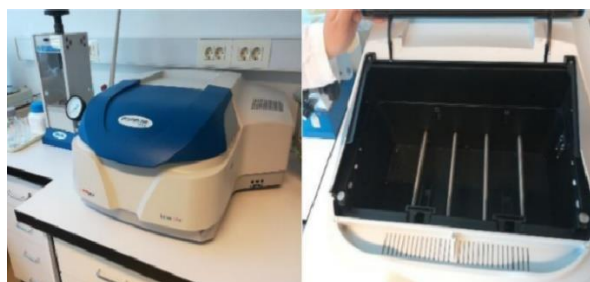
Slika 32. UV-Vis spektrofotometar Specord 200 Plus
