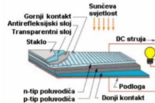
Slika 4. Spajanje PN spoja vanjskim strujnim krugom 13
