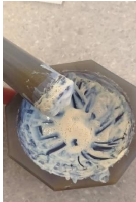
Slika 22. Pripremljena pasta nanokristaličnog praha ZnO s kiselinom
