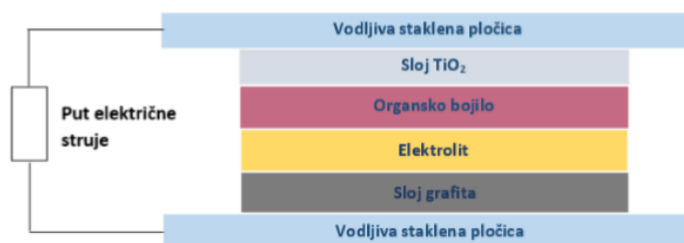
Slika 16. Shematski prikaz Grätzelove solarne ćelije 29
