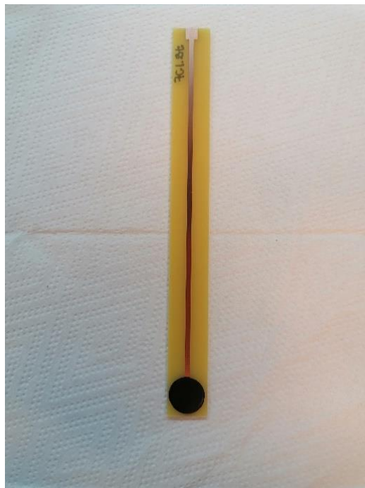
Slika 7. Tijelo elektrode zajedno s postavljenom membranom
