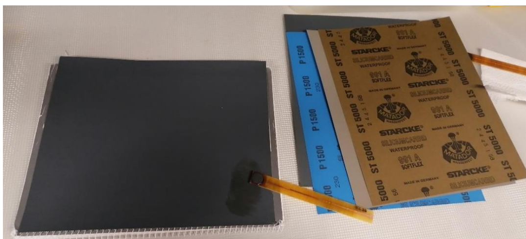
Slika 9. Brusni papir korišten za poliranje
