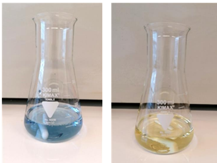
Slika 2.3 Prijelaz boje iz plave u žutu pri kompleksometrijskom određivanju olova.
