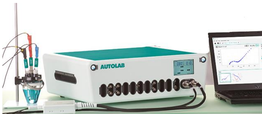
Slika 18. Elektrokemijska ćelija sa postavljnim elektrodama (lijevo) i potencijostat sa računalom (desno).
