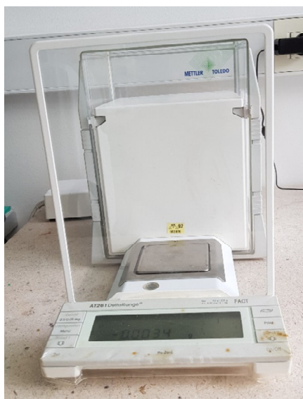
Slika 7. Analitička vaga - AT261 DeltaRange (Mettler Toledo, Švicarska)
