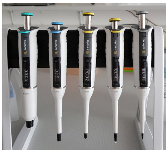
Slika 8. Tacta mehaničke pipete - (Sartorius, Njemačka)
