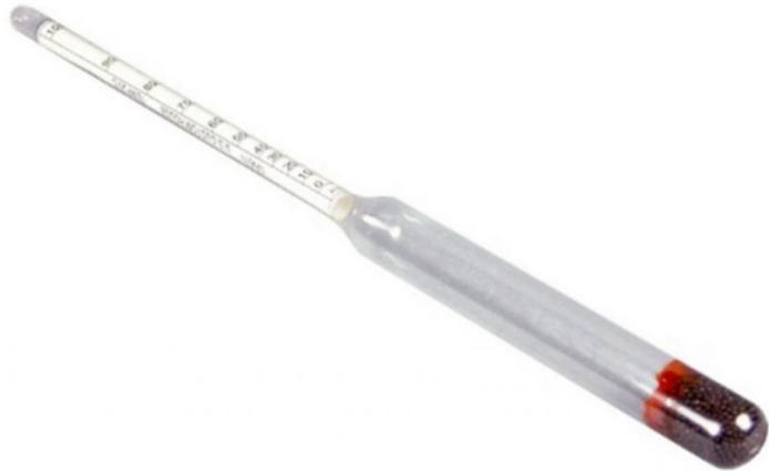
Slika 11. Alkohometar s ugrađenim termometrom (30)
