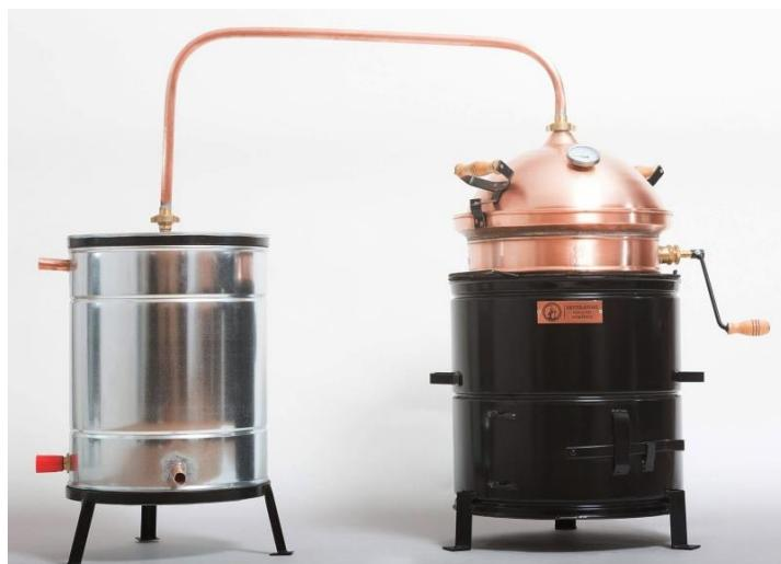
Slika 10. Jednostavni uređaj za destilaciju (29)
