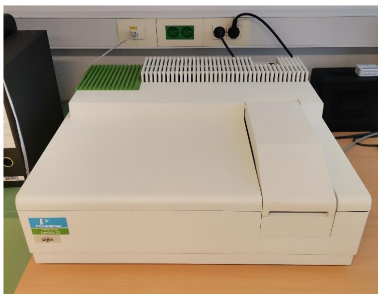
Slika 12. Perkin Elmer Lambda 25 UV/Vis spektrofotometar
