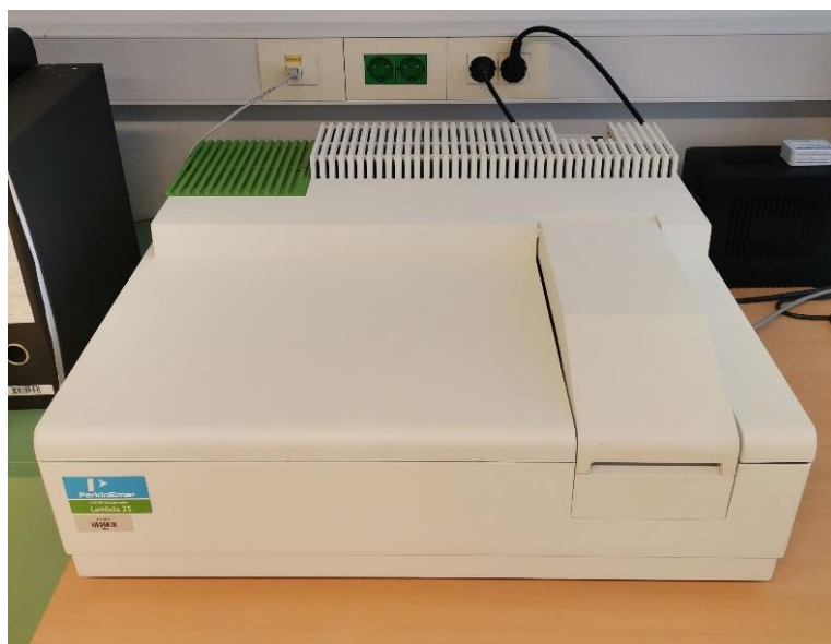
Slika 12. Perkin Elmer Lambda 25 UV/Vis spektrofotometar
