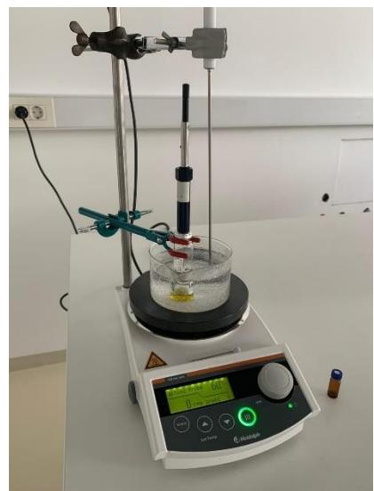
Slika 13. Aparatura za adsorpciju uzorka na sivo vlakno
