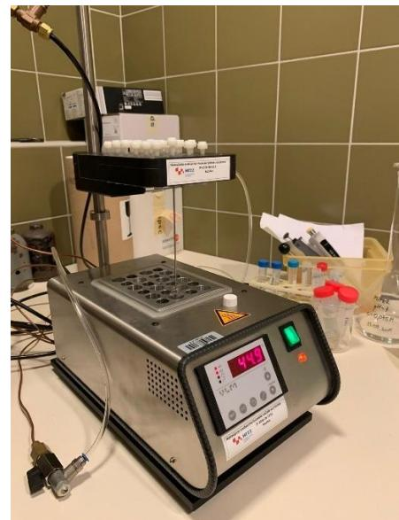
**Slika 10. Uredaj za uparavanje uzoraka EC-1V-130 (VLM, Njemačka)**
