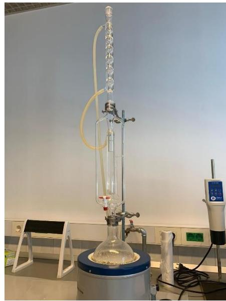
**Slika 9. Aparatura za vodenu destilaciju po Clevengeru**
