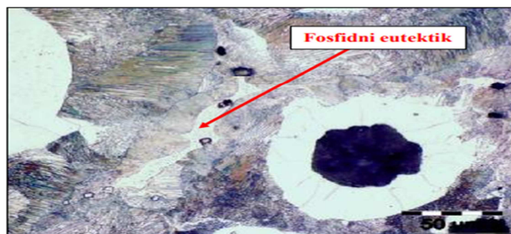
Slika 21. Metalografska snimka mikrostrukture uzorka taljevine nodularnog lijeva u nagriženom stanju (nital) [3]
