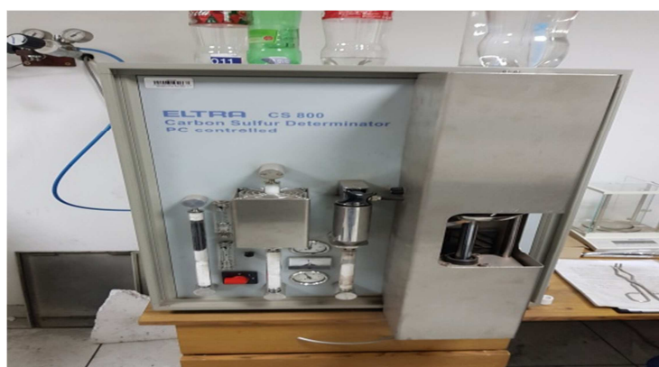
Slika 41. Uređaj za određivanje sadržaja ugljika i sumpora [24]
