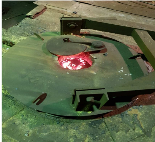
Slika 37. Upaljena elektropeč sa svim sastojcima [24]
