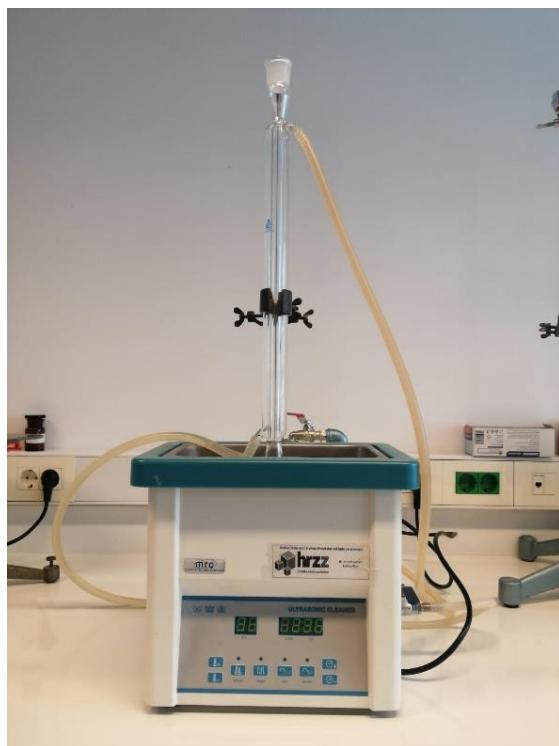
Slika 10. Aparatura za ultrazvučnu ekstrakciju
