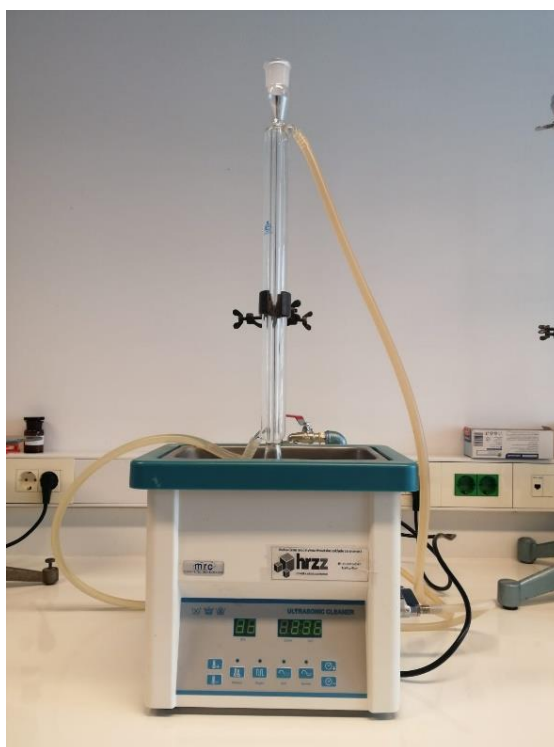
Slika 10. Aparatura za ultrazvučnu ekstrakciju
