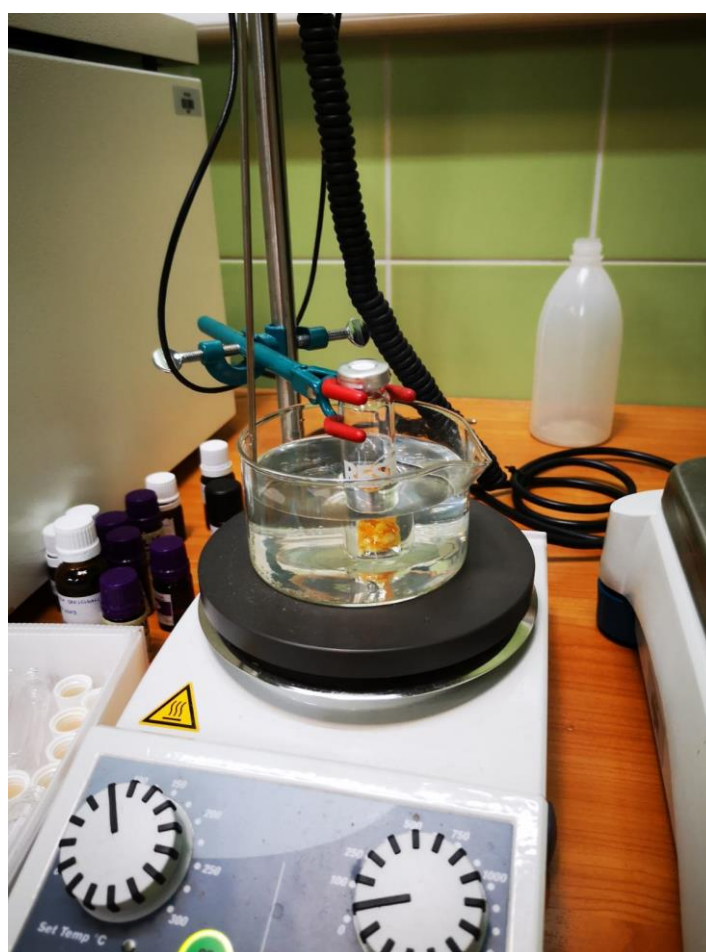
Slika 6. Aparatura za mikroekstrakciju vršnih para na krutoj fazi (HS-SPME)
