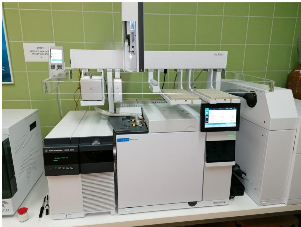
Slika 17. Vezani sustav plinska kromatografija-spektrometrija masa (GC-MS)
