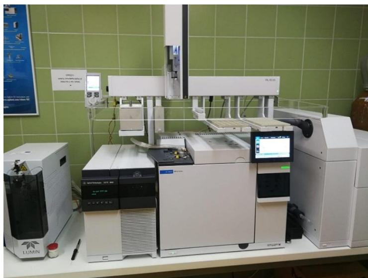
**Slika 14.** Uredaj vezanog sustava plinske kromatografije-spektrometrije masa GC-MS
