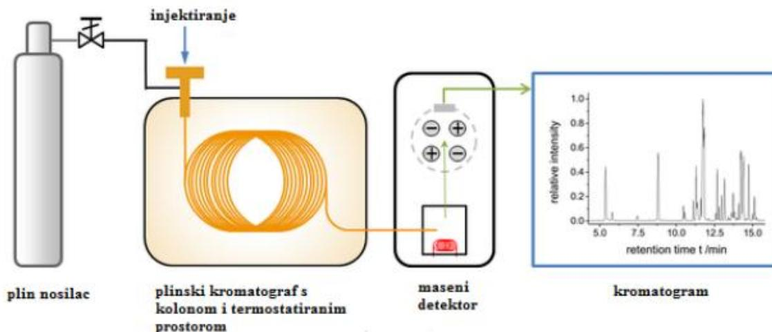
Slika 11. Vezani sustav plinske kromatografije i spektrometrije masa GC/MS<sup>28</sup>
