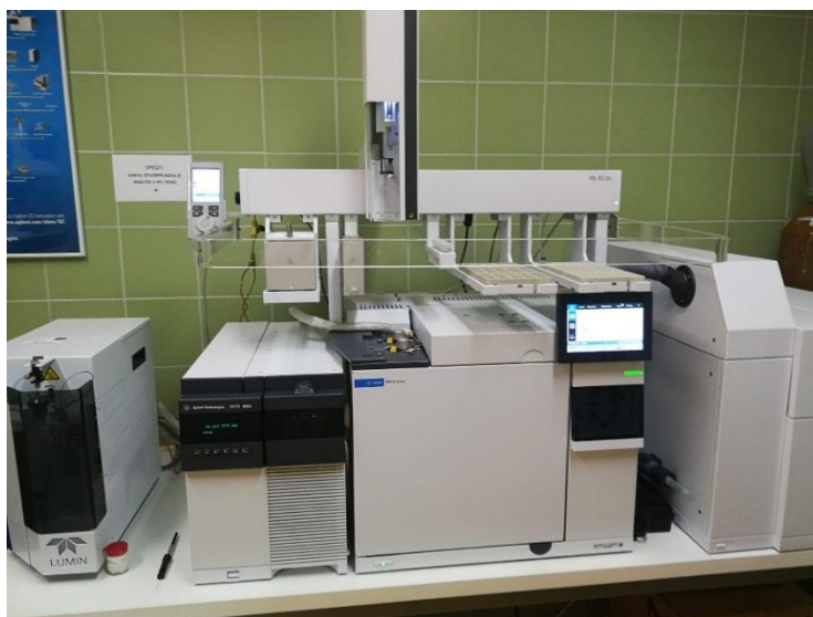
Slika 14. Uređaj vezanog sustava plinske kromatografije-spektrometrije masa GC-MS
