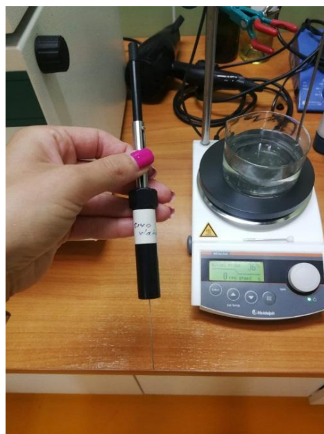
Slika 15. SPME Iгла sa sivim vlaknom
