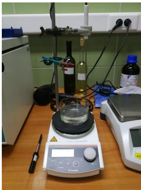
Slika 12. Aparatura potrebna za mikroekstrakciju vršnih para na čvrstoj fazi HS-SPME
