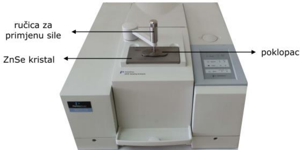
Slika 12. FT-IR spektrometar Spectrum One (Perkin-Elmer) s dodatkom za snimanje HATR tehnikom 37
