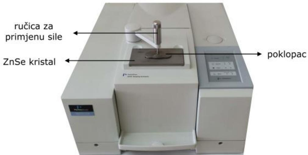
Slika 12. FT-IR spektrometar Spectrum One (Perkin–Elmer) s dodatkom za snimanje HATR tehnikom<sup>37</sup>
