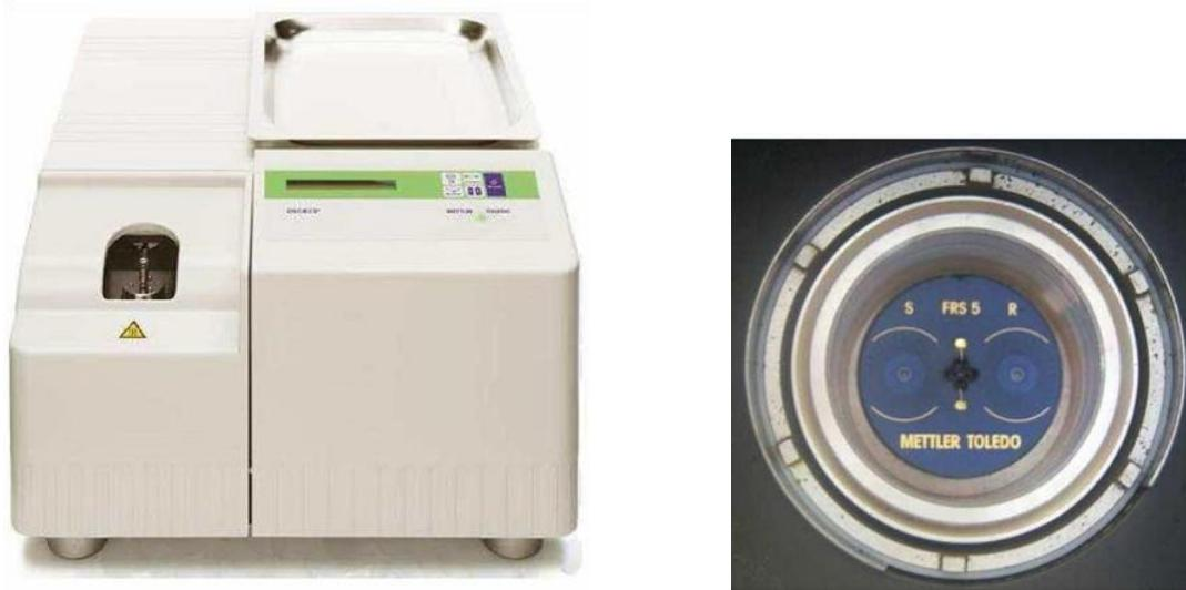
Slika 14. a) Diferencijalni pretražni kalorimetar DSC 823e (MettlerToledo, Švicarska) i b)
