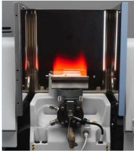
Slika 6. Prikaz atomizacije plamenom. 12
