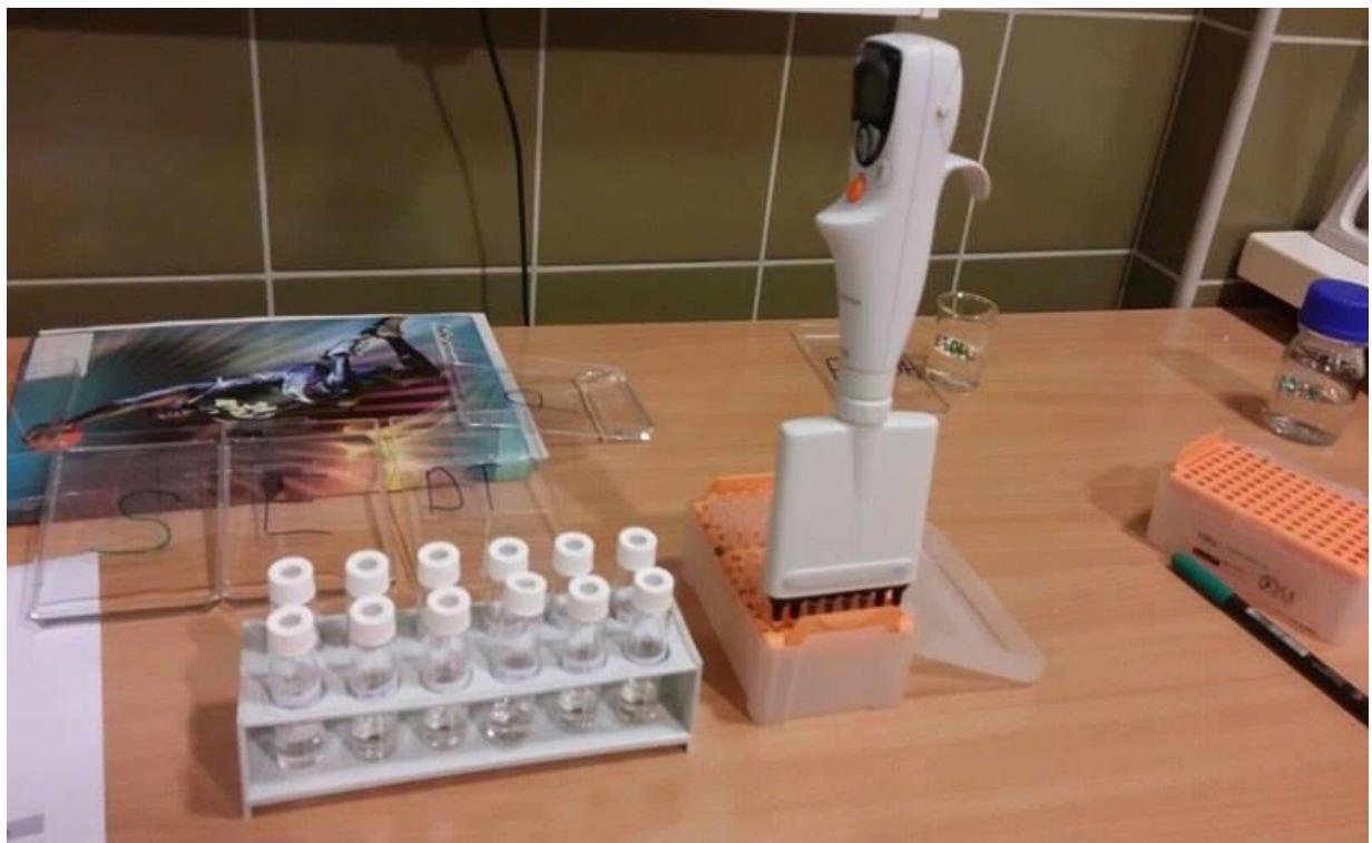
*Slika 12. Automatska mikropipeta i otopine različitih koncentracija inhibitora*
