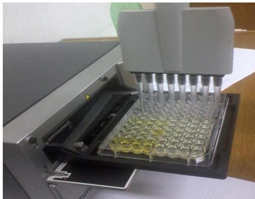
**Slika 14.** Dodavanje ATChI neposredno prije mjerjenja na višekanalnom čitaču mikrotitarskih pločica Sunrise
