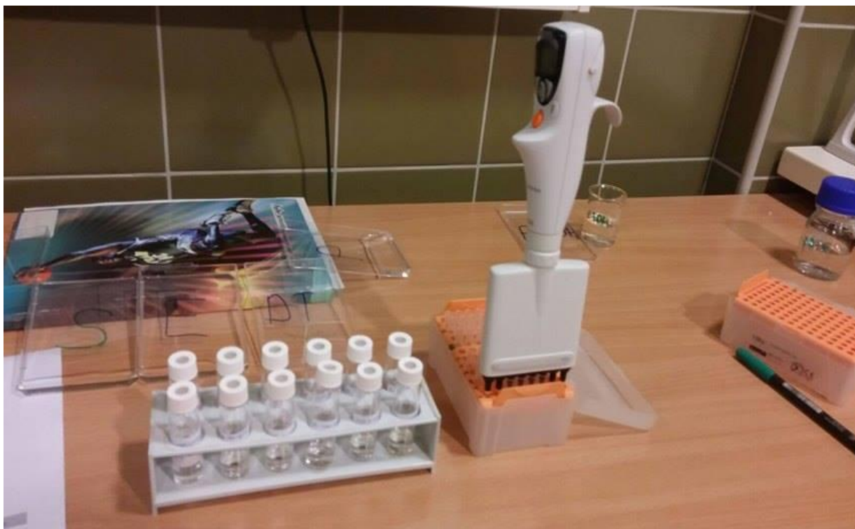
Slika 12. Automatska mikropipeta i otopine različitih koncentracija inhibitora
