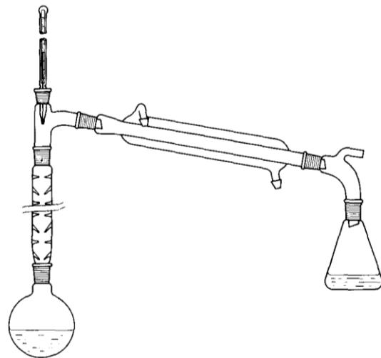
Slika 8. Aparatura za frakcijsku destilaciju<sup>16</sup>
