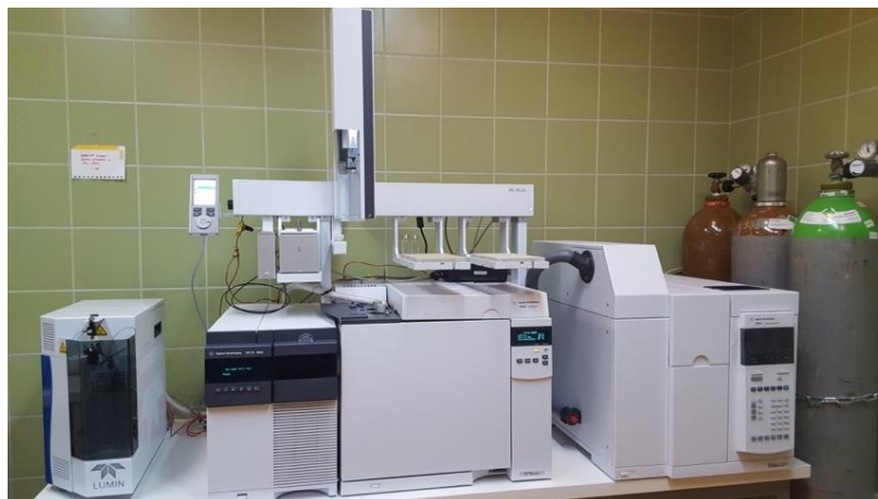
Slika 9. Vezani sustav GC-MS u Zavodu za organsku kemiju Kemijско-tehnološkog fakulteta u Splitu
