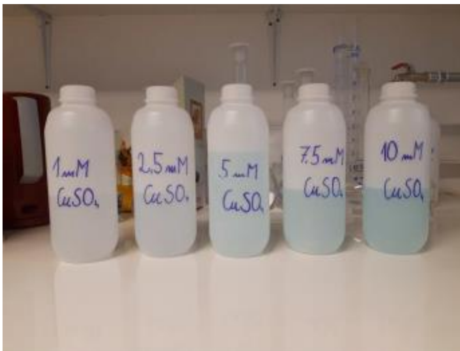
Slika 2.3. Vodene otopine \text{CuSO}_4 \times 5\text{H}_2\text{O} u kojima su provedena elektrokemijska mjerenja
