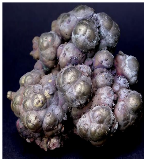
Slika 1.7. Plikasti bakar dobiven iz halkozina 22
