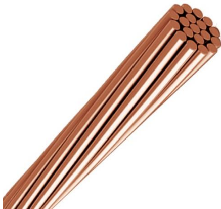
Slika 1.8. Bakar izvučen u tanke žice 23
