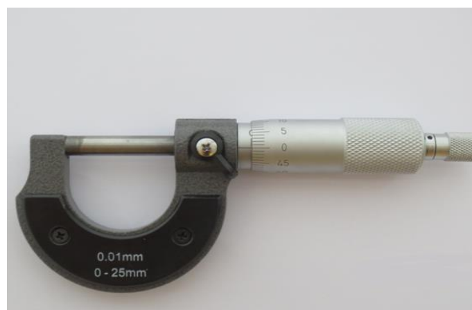
Slika 12. Lux-tools Comfort mikrometarski vijak 0-0,25 x 0,01 mm za određivanje dimenzija ispitivanih čvrstih čestica.
