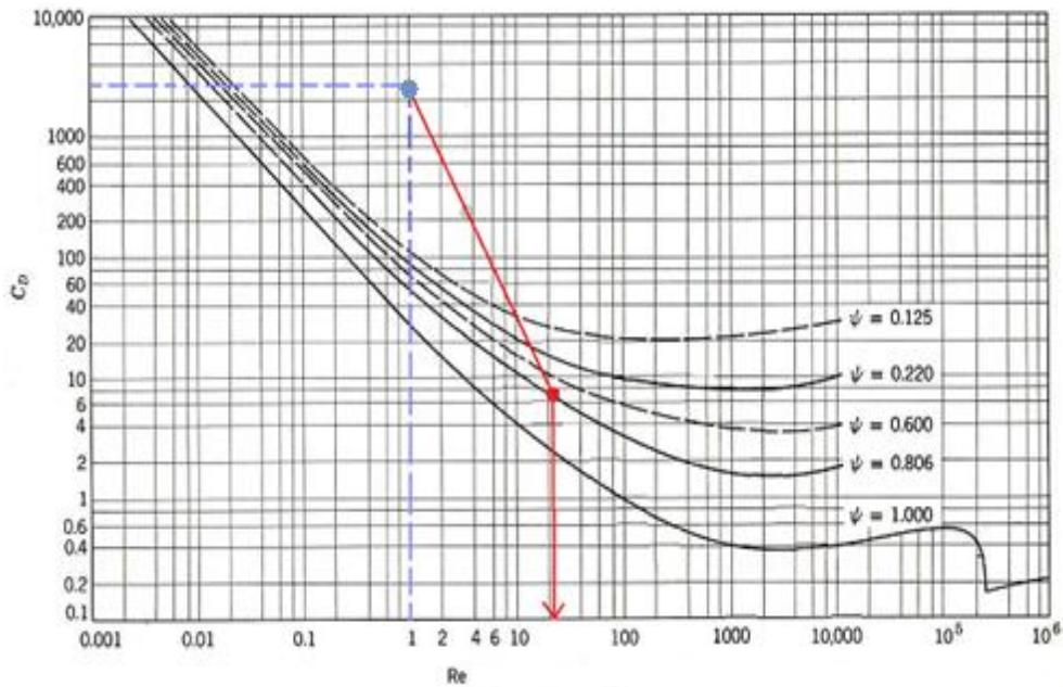
**Slika 24.** Određivanje brzine taloženja čestice oblika kocke primjenom  $C_D - Re$  dijagrama (  $d_c = 3,4 \cdot 10^{-3} \text{ m}$  ;  $\Psi = 0,806$  ;  $\rho_c = 2545,90 \text{ kg m}^{-3}$ ;  $\rho_f = 1194,28 \text{ kg m}^{-3}$ ;  $\mu_f = 0,035 \text{ Pa s}$ ;  $w_G = 0,7$  ).
