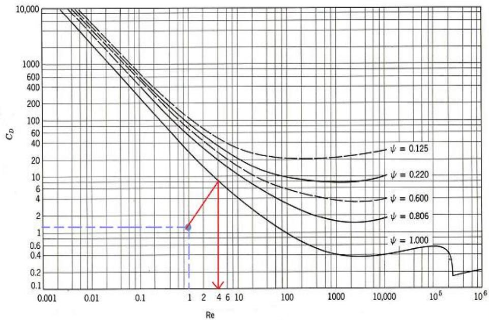
**Slika 23.** Određivanje promjera čestice sferičnog oblika poznate brzine taloženja primjenom  $C_D - Re$  dijagraama ( $\rho_c = 1232,75 \text{ kg m}^{-3}$ ;  $v_t = 0,021 \text{ m s}^{-1}$ ;  $\Psi = 1$ ;  $\rho_f = 1194,28 \text{ kg m}^{-3}$ ;  $\mu_f = 0,035 \text{ Pa s}$ ;  $w_G = 0,7$ ).
