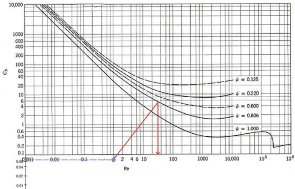
**Slika 27.** Određivanje ekvivalentnog promjera čestice oblika kocke poznate brzine taloženja primjenom  $C_D - Re$  dijagrama ( $\Psi = 0,803$ ;  $v_t = 0,183 \text{ m s}^{-1}$ ;  $\rho_c = 2545,90 \text{ kg m}^{-3}$ ;  $\rho_f = 1194,28 \text{ kg m}^{-3}$ ;  $\mu_f = 0,035 \text{ Pa s}$ ;  $w_G = 0,7$ ).
