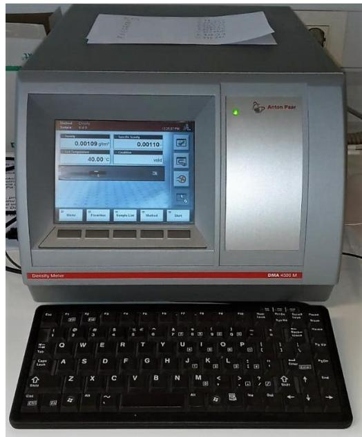
**Slika 14.** Digitalni mjerač gustoće tipa Anton Paar DEM 4500 M Chemicals.
