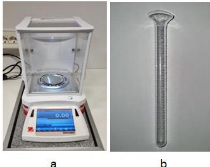
**Slika 13.** Analitička vaga Explorer™ Analytical za određivanje mase ispitivanih čestica (a) i graduirana staklena kiveta za određivanje gustoće (b).
