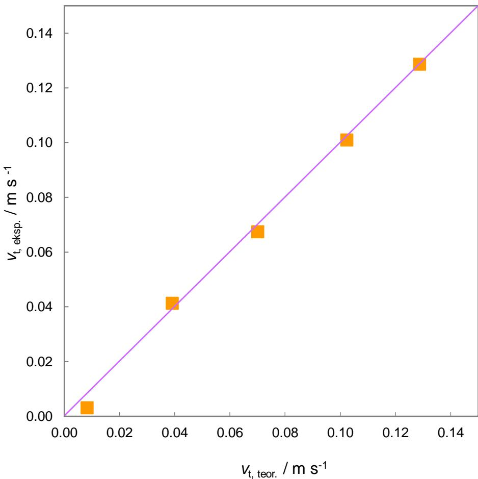
**Slika 29.** Usporedba eksperimentalno i teorijski dobivenih vrijednosti brzina taloženja čestica oblika valjka u otopinama glicerola različitih gustoća ( $d_{\text{ekv}} = 6,70 \cdot 10^{-3} \text{ m}$ ;  $\Psi = 0,832$ ;  $\rho_c = 1577,26 \text{ kg m}^{-3}$ ;  $WG = 0,5-1,0$ ).
