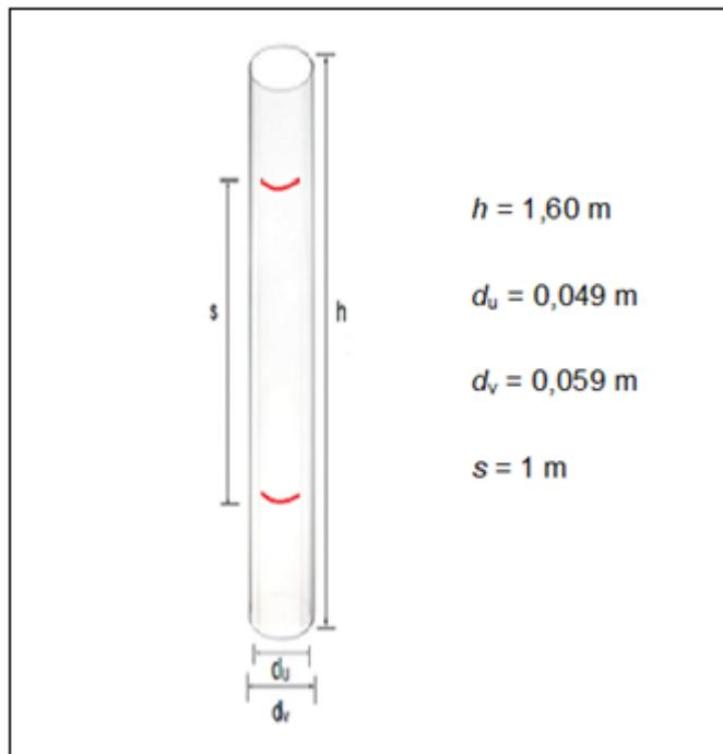
**Slika 10.** Geometrijske karakteristike kolone za određivanje brzine taloženja.
