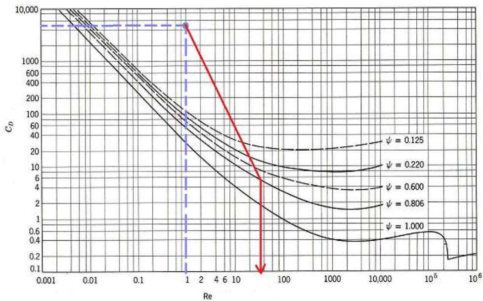
**Slika 25.** Određivanje brzine taloženja čestice oblika kocke primjenom  $C_D - Re$  dijagrama (  $d_c = 10,2 \cdot 10^{-3} \text{ m}$  ;  $\Psi = 0,806$  ;  $\rho_c = 1388,67 \text{ kg m}^{-3}$ ;  $\rho_f = 1194,28 \text{ kg m}^{-3}$ ;  $\mu_f = 0,035 \text{ Pa s}$ ;  $w_G = 0,7$  ).
