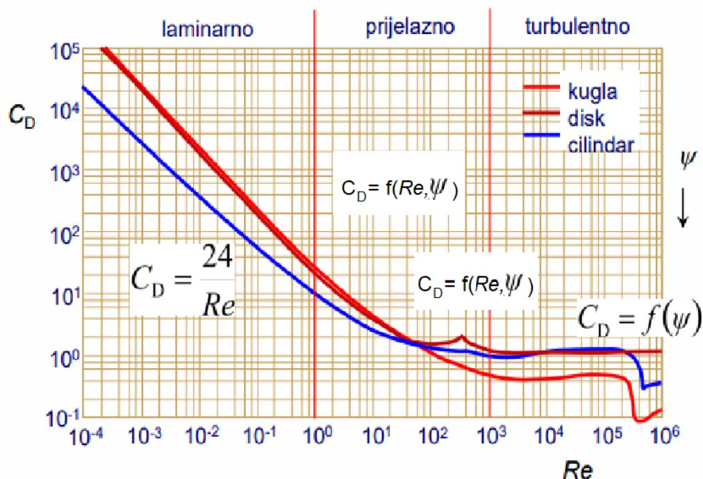
**Slika 5.** Ovisnost faktora otpora,  $C_D$ , o Reynoldsovom značajci za različita hidrodinamička područja optjecanja <sup>8</sup>.
