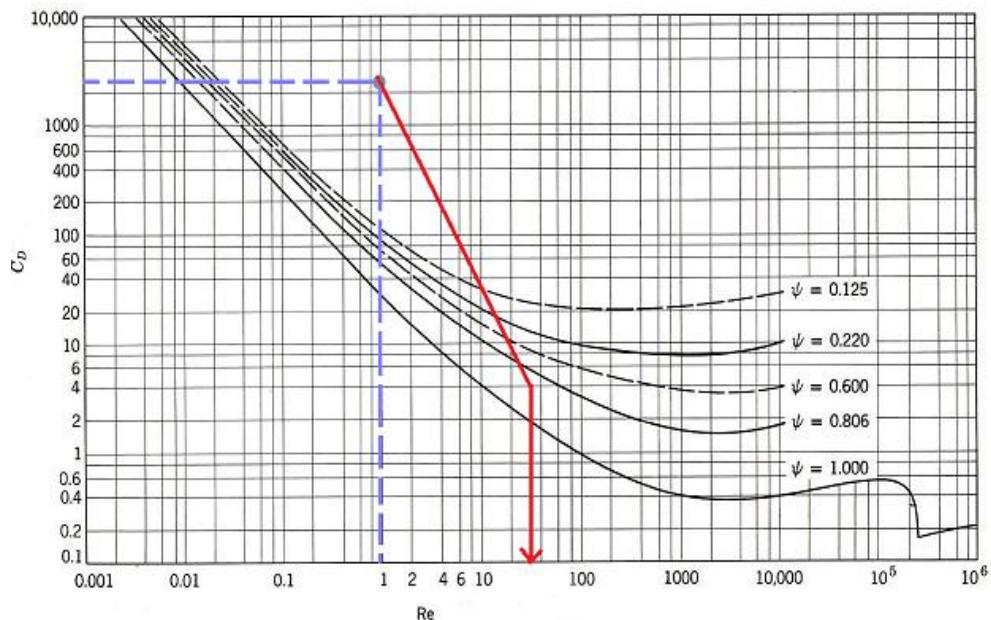
**Slika 26.** Određivanje brzine taloženja čestice oblika valjka primjenom  $C_D - Re$  dijagrama (  $d_c = 10,0 \cdot 10^{-3} \text{ m}$  ;  $\Psi = 0,874$  ;  $\rho_c = 1328,80 \text{ kg m}^{-3}$ ;  $\rho_f = 1194,28 \text{ kg m}^{-3}$ ;  $\mu_f = 0,035 \text{ Pa s}$ ;  $w_G = 0,7$  ).
