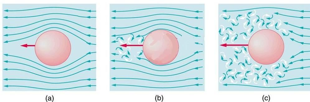
**Slika 2.** Laminarno (a), prijelazno (b) i turbulentno optjecanje (c)<sup>3</sup>.
