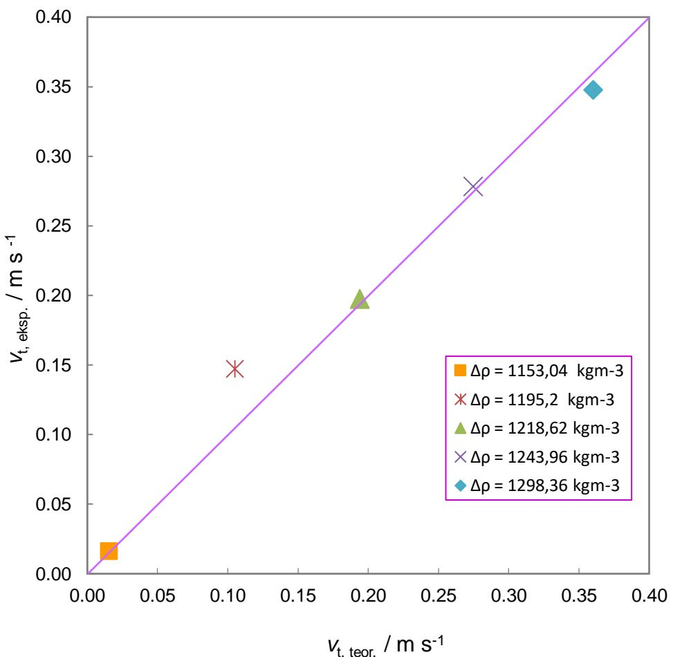
**Slika 21.** Usporedba eksperimentalno i teorijski dobivenih vrijednosti brzina taloženja sferičnih čestica u otopinama glicerola različitih gustoća ( $d_c = 5 \cdot 10^{-3} \text{ m}$ ;  $\rho_c = 2412,90 \text{ kg m}^{-3}$ ;  $\Psi = 1$ ;  $w_G = 0,5\text{-}1,0$ ).
