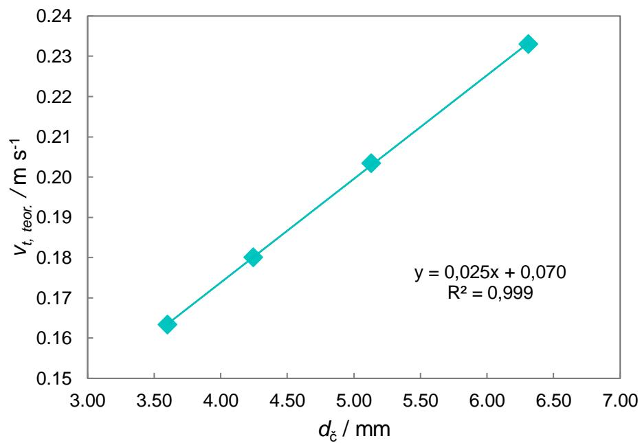
**Slika 18.** Utjecaj promjera sferičnih čestica na brzinu taloženja određen eksperimentalno i teorijski ( $\rho_c = 2709,64 \text{ kg m}^{-3}$ ;  $\Psi = 1$ ;  $\rho_f = 1194,28 \text{ kg m}^{-3}$ ;  $\mu_f = 0,035 \text{ Pa s}$ ;  $w_G = 0,7$ ).
