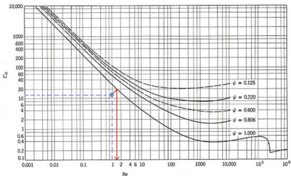
**Slika 17.** Postupak određivanja nepoznatog promjera čvrstih čestica na temelju poznate brzine položenja primjenom  $C_D - Re$  dijagrama.
