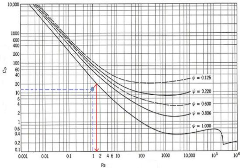
**Slika 22.** Određivanje promjera čestice sferičnog oblika poznate brzine taloženja primjenom  $C_D - Re$  dijagrama ( $\rho_c = 1264,81 \text{ kg m}^{-3}$ ;  $v_t = 0,012 \text{ m s}^{-1}$ ;  $\psi = 1$ ;  $\rho_f = 1194,28 \text{ kg m}^{-3}$ ;  $\mu_f = 0,035 \text{ Pa s}$ ;  $W_G = 0,7$ ).
