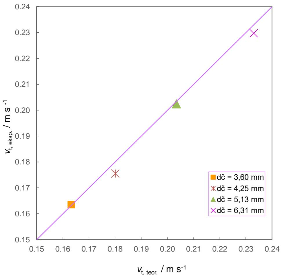
**Slika 19.** Usporedba eksperimentalno i teorijski dobivenih vrijednosti brzina taloženja sferičnih čestica različitih veličina ( $\rho_c = 2709,64 \text{ kg m}^{-3}$ ;  $\Psi = 1$ ;  $\rho_f = 1194,28 \text{ kg m}^{-3}$ ;  $\mu_f = 0,035 \text{ Pa s}$ ;  $w_G = 0,7$ ).
