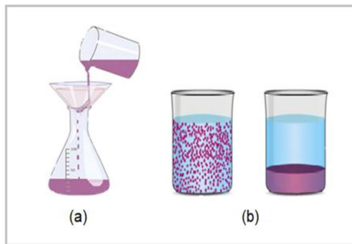
**Slika 1.** Primjeri optjecanja - mehanička operacija filtracije (a) i gravitacijsko taloženje (b)<sup>1,2</sup>.
