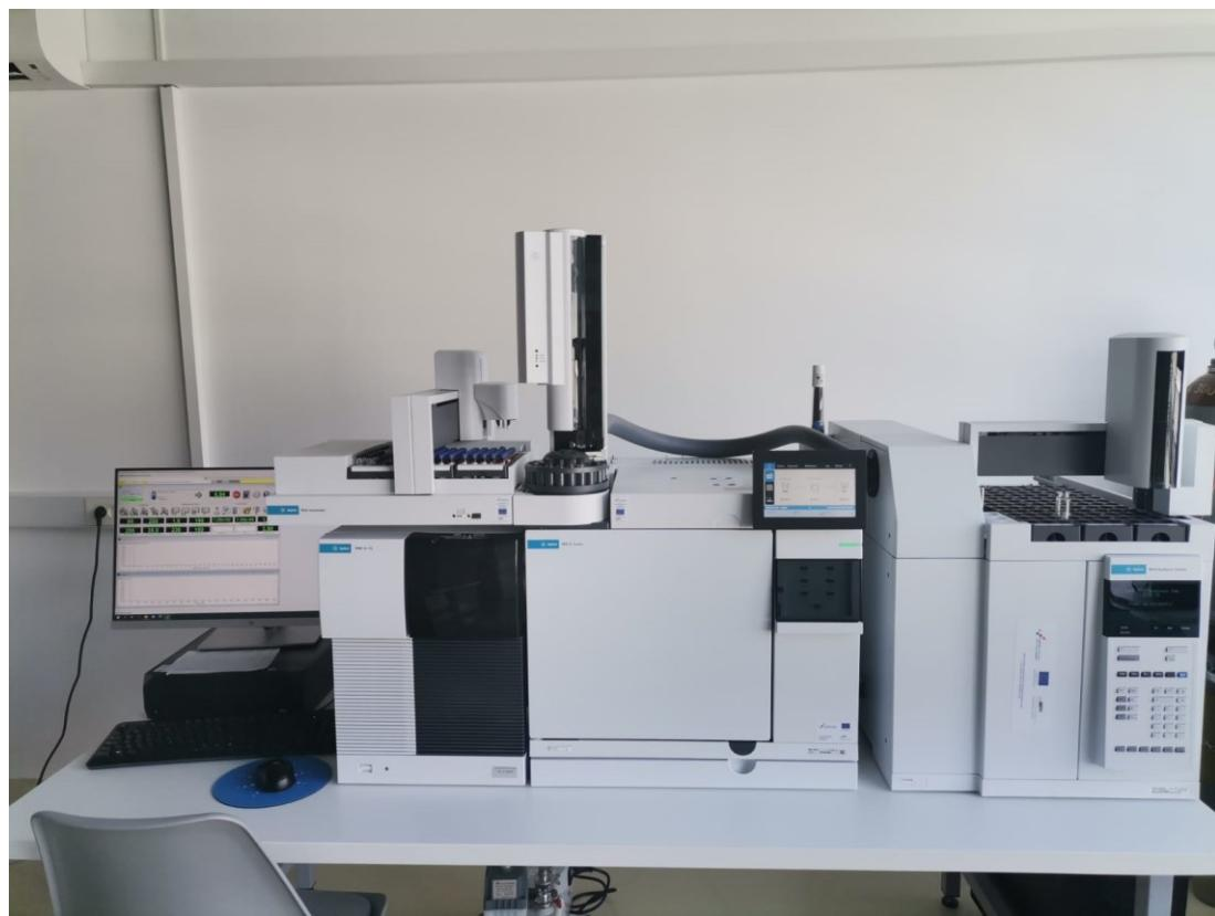
**Slika 6.** Plinski kromatograf s tandemskim spektrometrom masa
