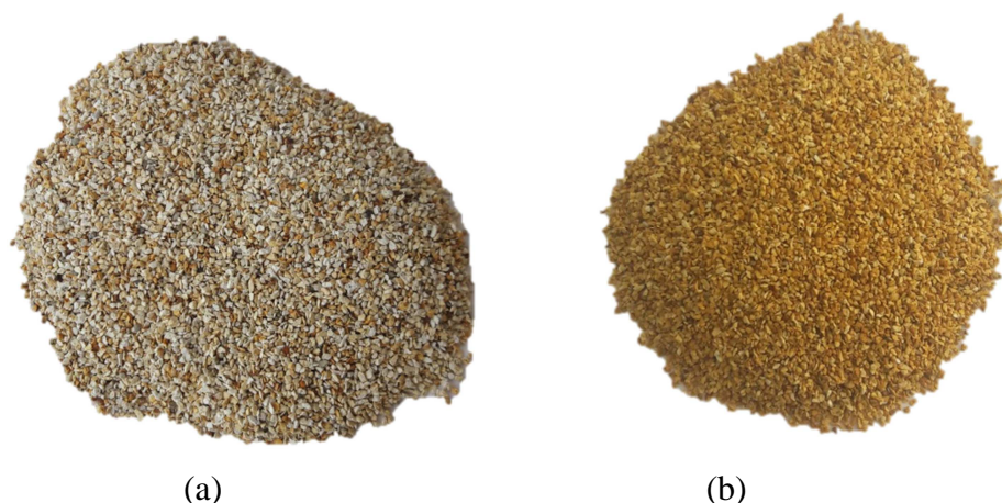
Slika 2.1. Usporedba (a) prirodnog i (b) Fe(III)-modificiranog zeolita.
