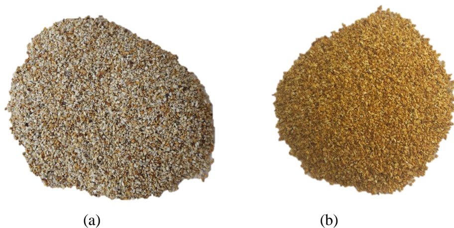
Slika 2.1. Usporedba (a) prirodnog i (b) Fe(III)-modificiranog zeolita.
