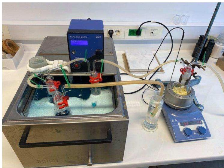
**Slika 9.** Aparatura za destilaciju sa dušikom i trapovima
