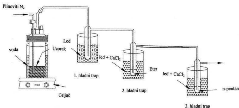
Slika 4. Aparatura za destilaciju s dušikom i trapovima <sup>11</sup>
