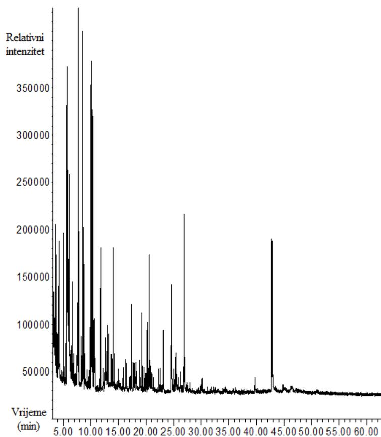
**Slika 12.** Kromatogram ionske struje za uzorak Trap II dobiven nakon 3 h destiliranja sa dušikom.
