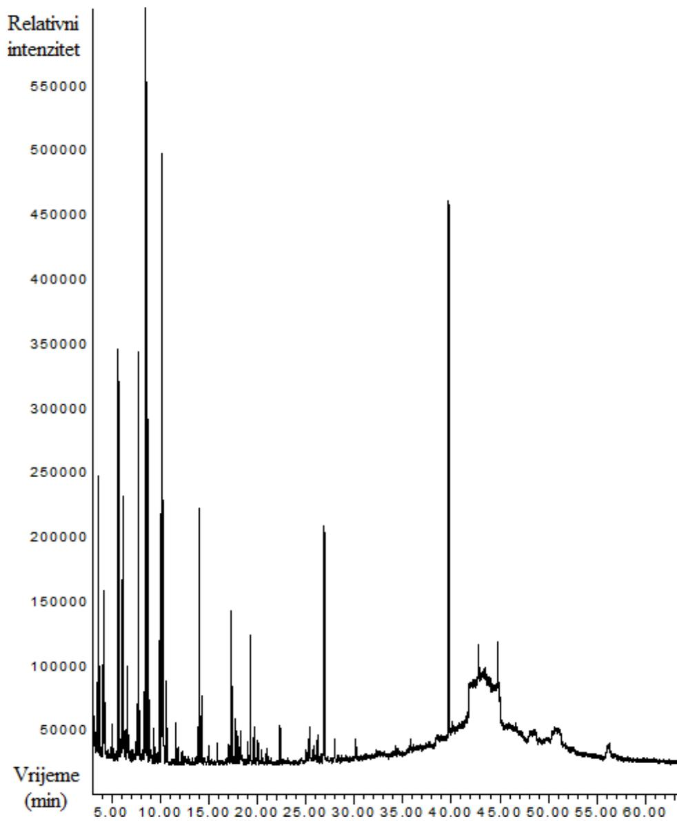
**Slika 13.** Kromatogram ionske struje za uzorak Trap II dobiven nakon 6 h destiliranja sa dušikom.
