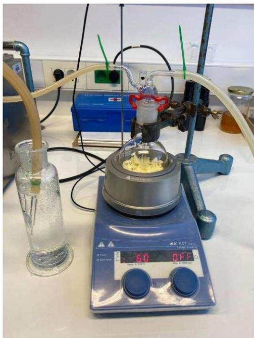
**Slika 8.** Aparatura za destilaciju sa dušikom i trapovima
