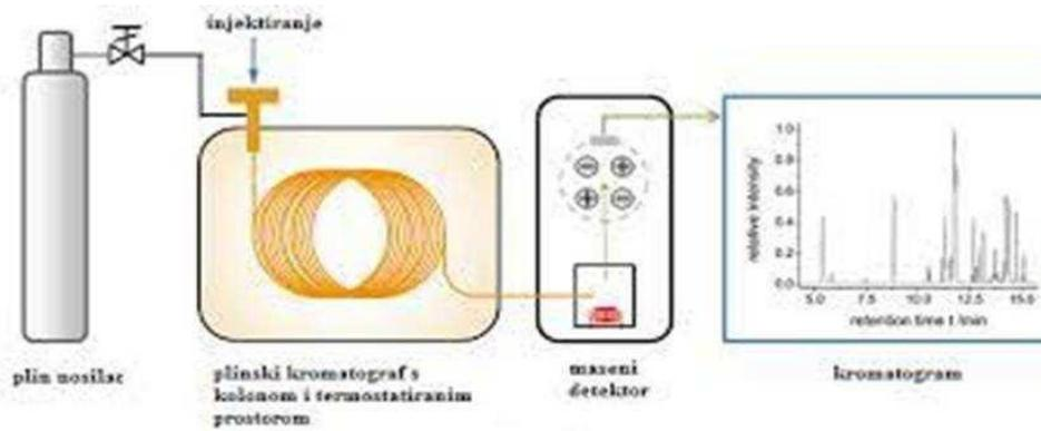
**Slika 6.** Shematski prikaz plinskog kromatografa s masenim spektrometrom (GC-MS)<sup>14</sup>
