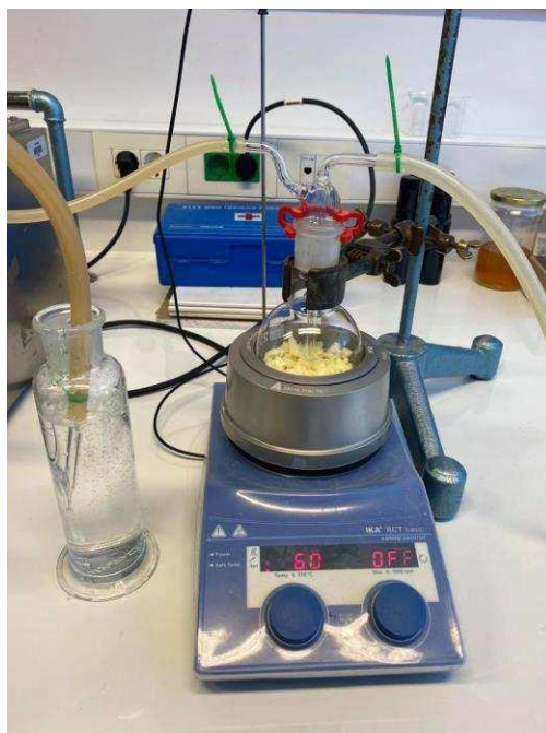
Slika 8. Aparatura za destilaciju sa dušikom i trapovima
