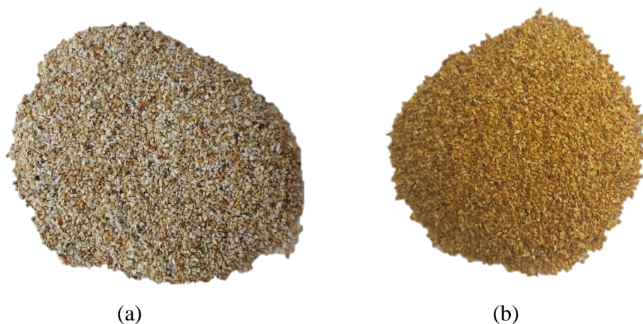
Slika 2.1. Usporedba (a) prirodnog i (b) Fe(III)-modificiranog zeolita.
