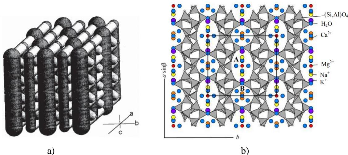
**Slika 1.13.** a) Model sustava kanala u jediničnoj ćeliji a) klinoptilolita<sup>32</sup> i b) prostorna struktura klinoptilolita<sup>35</sup>.
