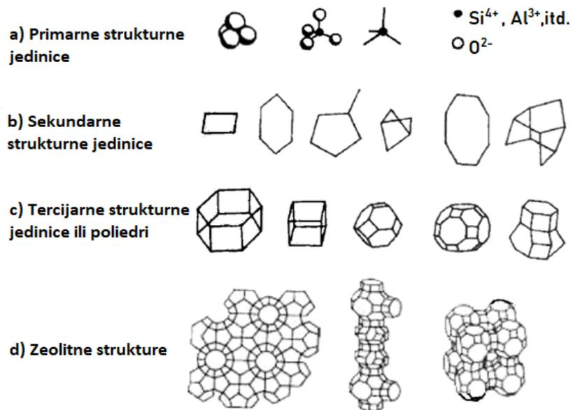
Slika 1.12. Razvoj zeolita od a) primarnih strukturnih jedinica, b) sekundarnih strukturnih jedinica, c) tercijarnih strukturnih jedinica do d) prostorno-mrežne strukture zeolita<sup>33</sup>.
