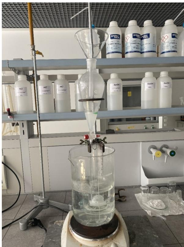
Slika 17. Aparatura za određivanje moći pjenjenja
