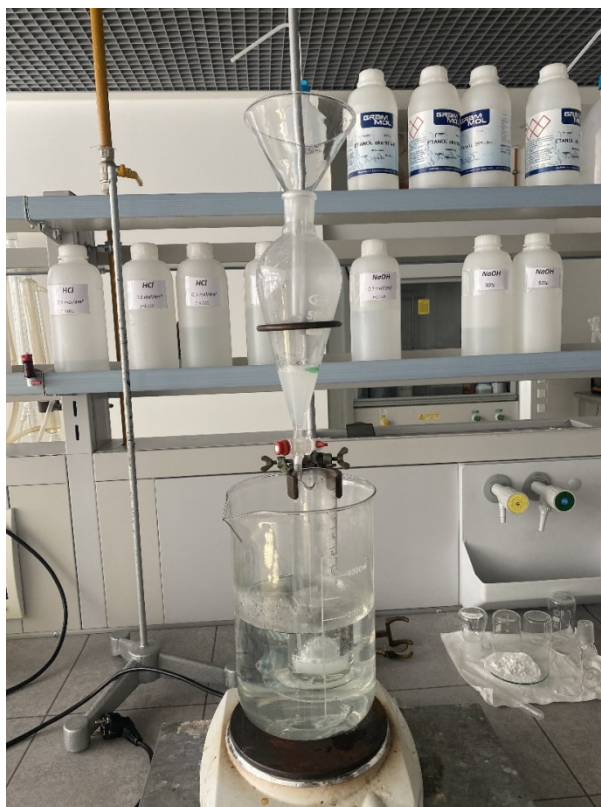
Slika 17. Aparatura za određivanje moći pjenjenja
