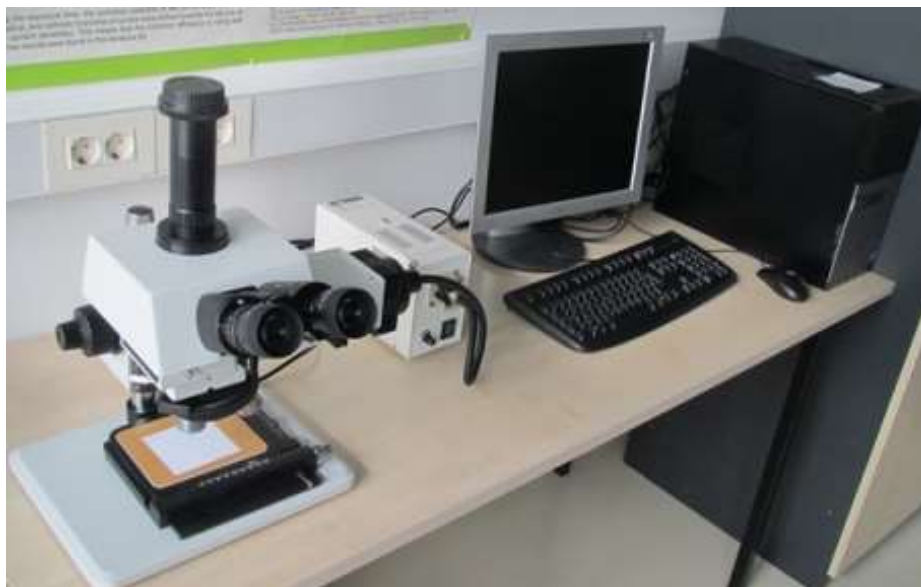
Slika 2.5. Optički mikroskop MXFMS-BD, Ningbo Sunny Instruments co.
