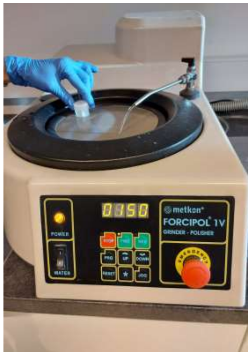
Slika 2.3. Uređaj za mehaničku obradu radne elektrode, Metkon Forcipol 1V
