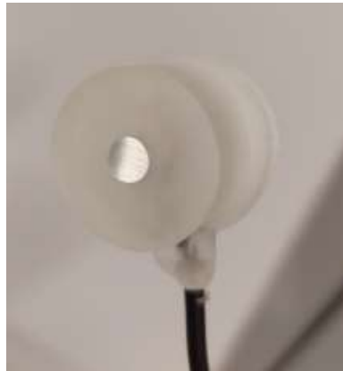
Slika 2.2. Elektroda od Sn na kojima su provedena mjerenja
