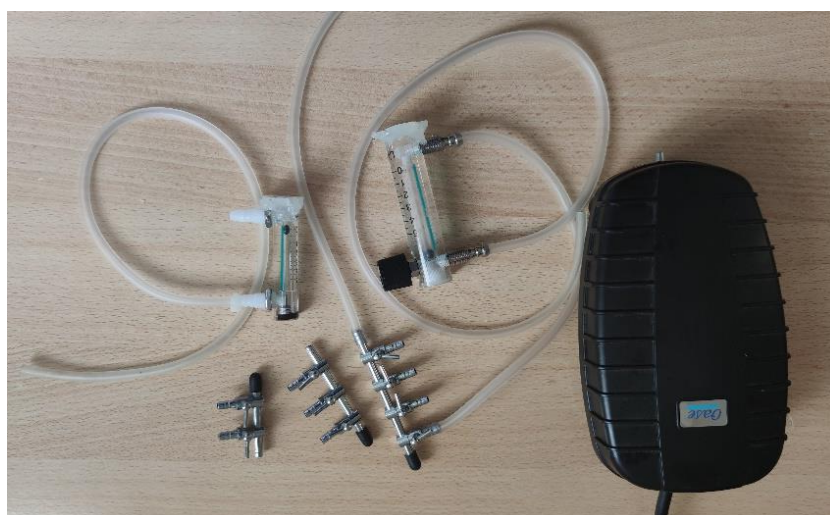
Slika 2.6. Zračni kompresor sa ventilima i rotametrima
