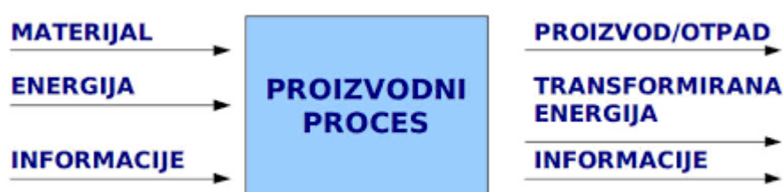
Slika 1.4. Opći prikaz proizvodnog procesa 33
