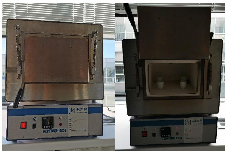
Slika 2.13. Uzorci pripremljeni za žarenje u peći na 500 °C
