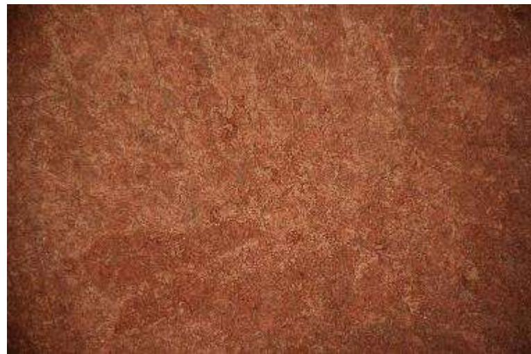
**Slika 34.** Površina CuAlMnZn elektrode nakon polarizacijskog mjerena u 1,5 % NaCl otopini uz uvećanje 100×
