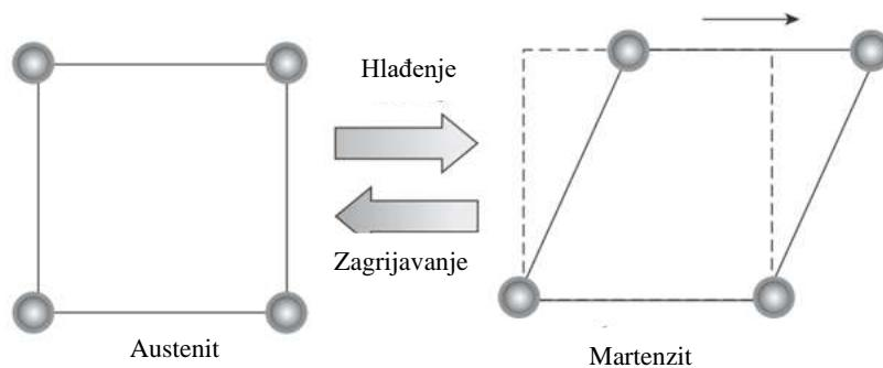
**Slika 5.** Prikaz promjene oblika jedinične čelije tijekom martenzitne transformacije<sup>24</sup>
