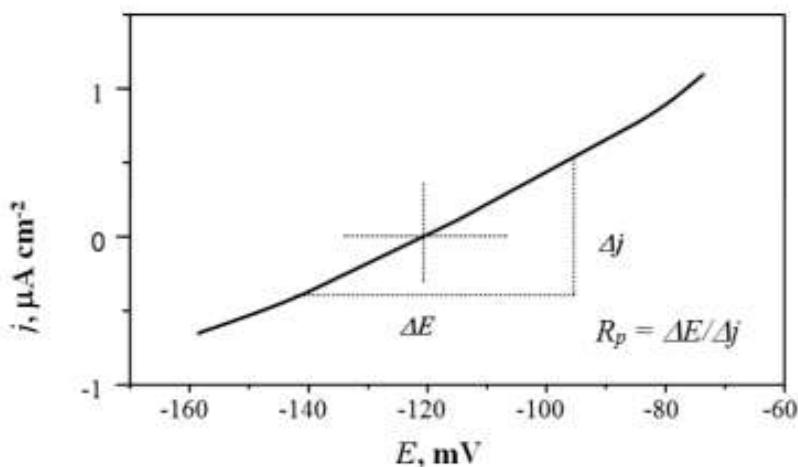
Slika 17. Određivanje polarizacijskog otpora metodom linearne polarizacije<sup>60</sup>
