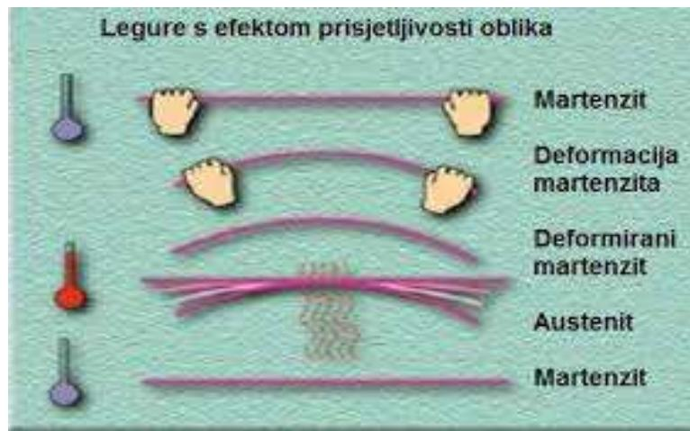
Slika 4. Transformacija legura s efektom prisjetljivosti oblika<sup>22</sup>
