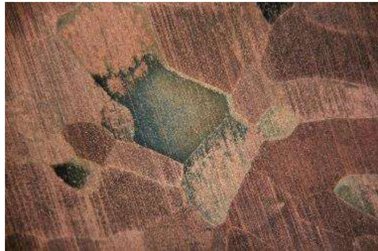
**Slika 31.** Površina CuAlMnZn elektrode nakon polarizacijskog mjerena u 0,1 % NaCl otopini
