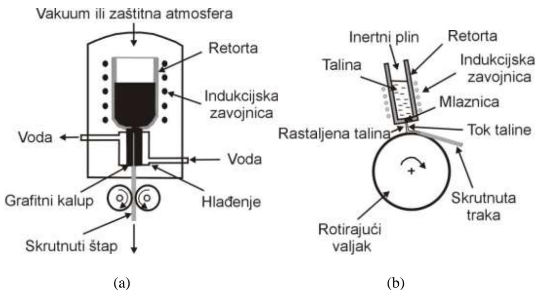
**Slika 11.** Shematski prikaz tehnike kontinuiranog vertikalnog lijevanja legure (a) i melt spinning tehniku (b)<sup>31</sup>
