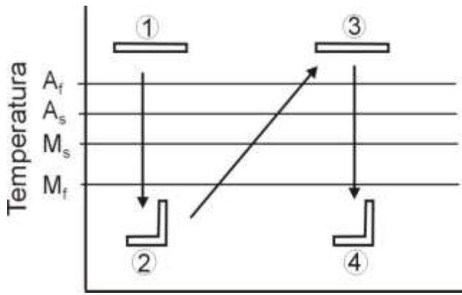
**Slika 9.** Shematski prikaz dvostrjnog efekta prisjetljivosti oblika<sup>4</sup>
