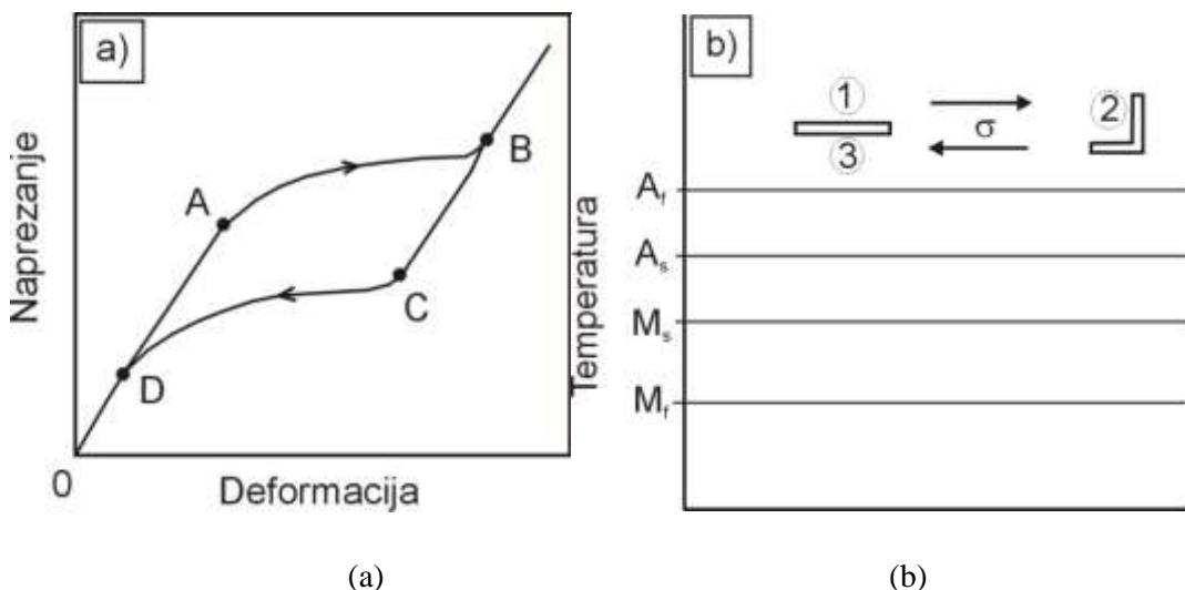
**Slika 10.** Prikaz dijagrama naprezanje – deformacija legure s prisjetljivosti oblika (a) i shematski prikaz pseudoelastičnosti (b)<sup>4</sup>
