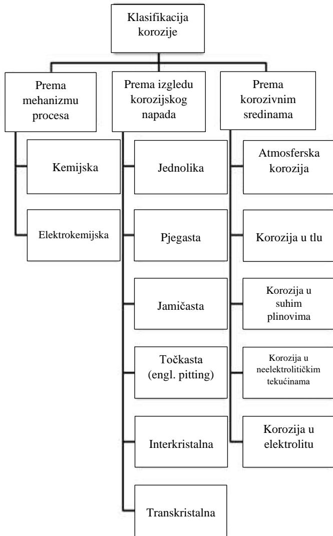
**Slika 13. Klasifikacija korozijskh procesa<sup>1</sup>**
