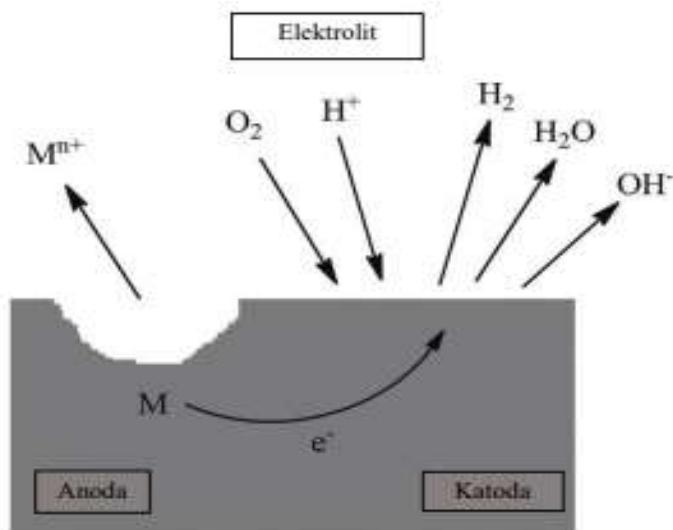
**Slika 15. Mehanizam elektrokemijske korozije<sup>46</sup>**
