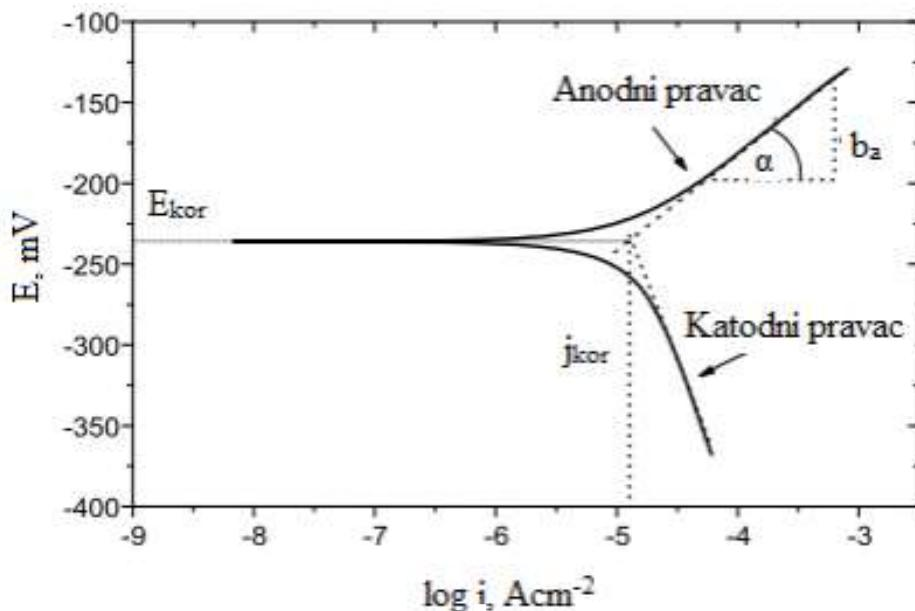
**Slika 18.** Metoda određivanja korozijskih parametara iz polarizacijskih mjerena (Tafelova metoda)<sup>8</sup>
