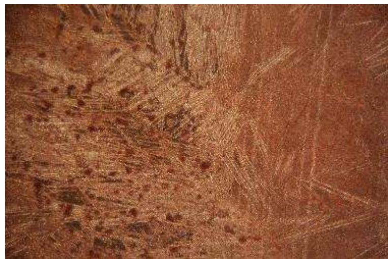
**Slika 32.** Površina CuAlMnZn elektrode nakon polarizacijskog mjerena u 0,5 % NaCl otopini
