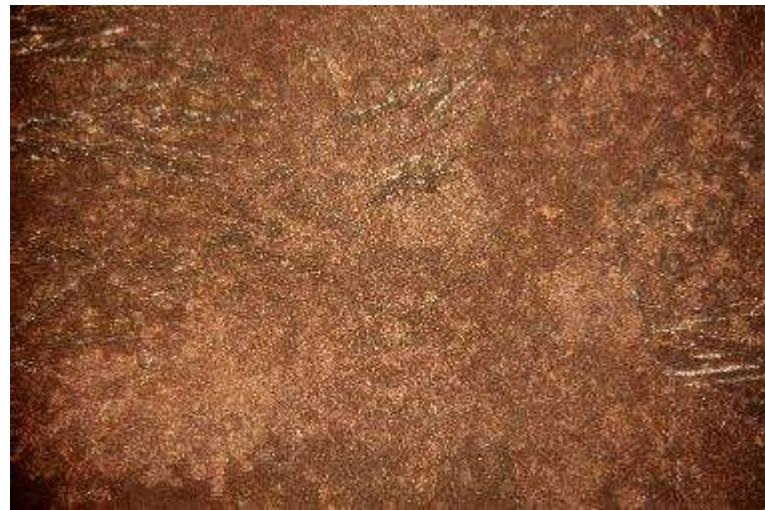
**Slika 33.** Površina CuAlMnZn elektrode nakon polarizacijskog mjerena u 0,9 % NaCl otopini uz uvećanje 100×
