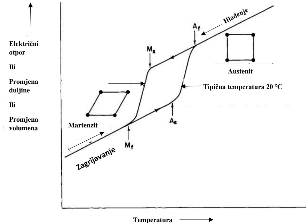
**Slika 6.** Hipotetski dijagram promjene svojstava u ovisnosti o temperaturi za martenzitnu transformaciju<sup>25</sup>
