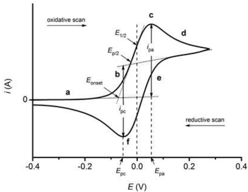
Slika 19. Ciklički voltamogram oksido-reduksijskog procesa sa glavnim točkama<sup>66</sup>
