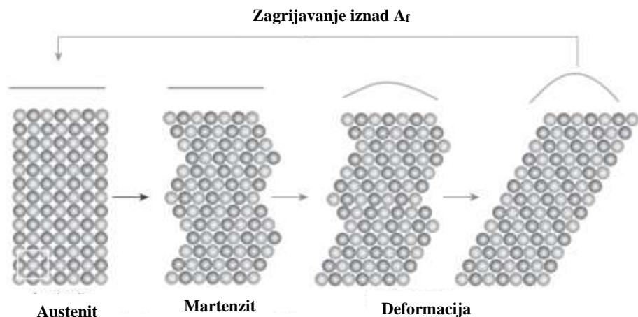
**Slika 7.** Mehanizam efekta prisjetljivosti oblika<sup>24</sup>
