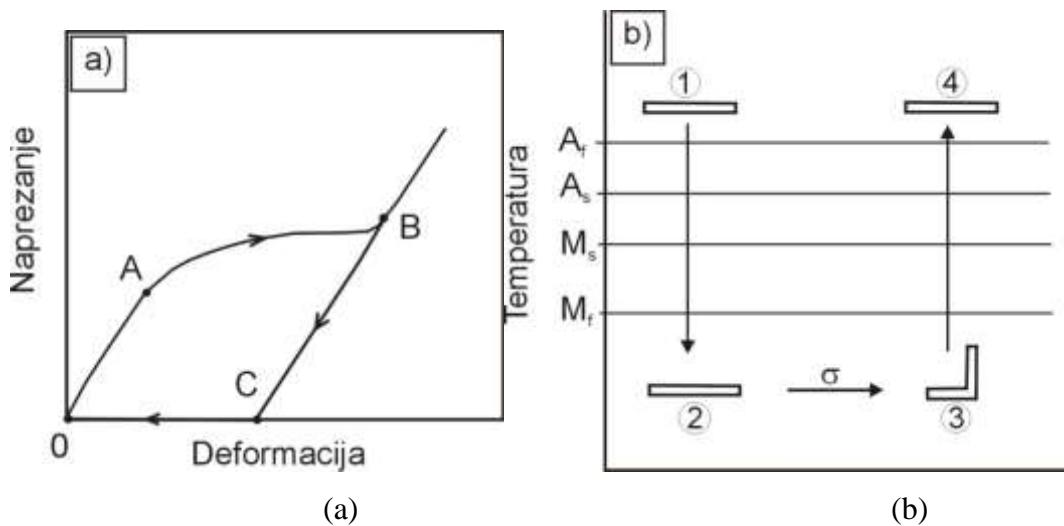
**Slika 8.** Prikaz dijagrama naprezanje – deformacija legure s prisjetljivosti oblika (a) i shematski prikaz jednosmjernog efekta prisjetljivosti oblika (b)<sup>4</sup>
