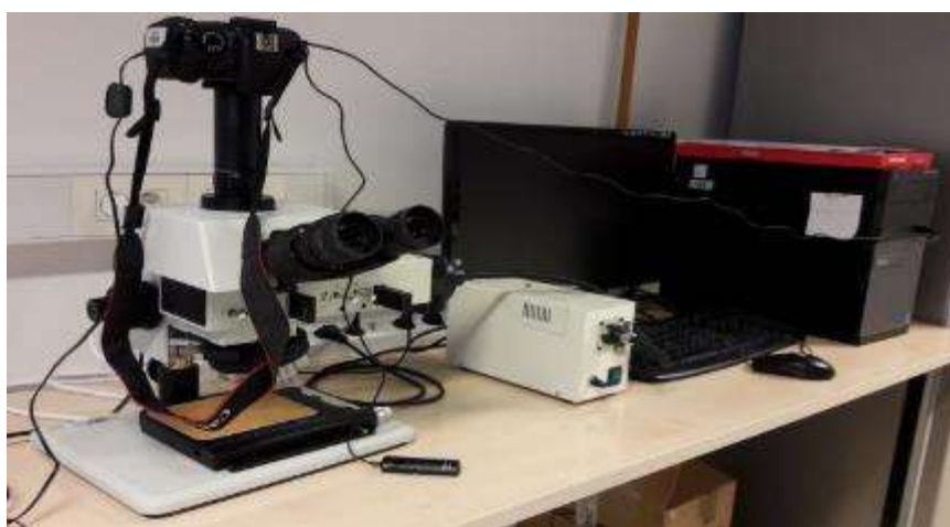
Slika 23. Svjetlosni mikroskop MXFMS-BD, Ningbo Sunny Instruments co. povezan s računalom
