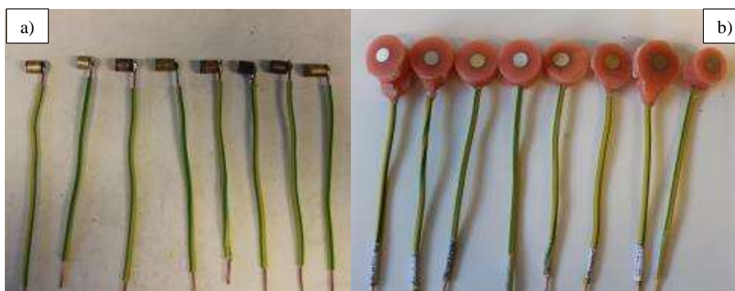
Slika 20. Izrada elektroda za elektrokemijska mjerenja
