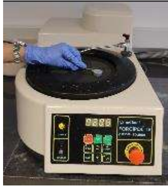
Slika 21. Mehanička obrada elektroda na uređaju Metkon Forcipol IV
