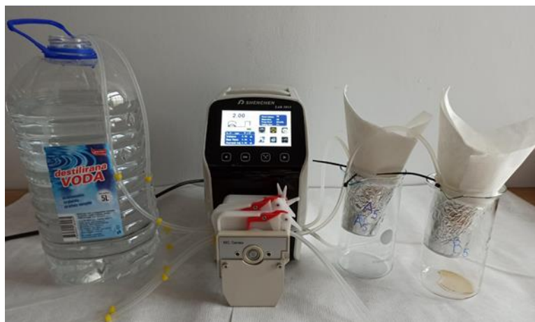
Slika 2.3 Prikaz simulacije procjedne vode
