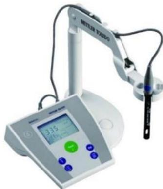
Slika 2.8 Konduktometar tipa Mettler Toledo
