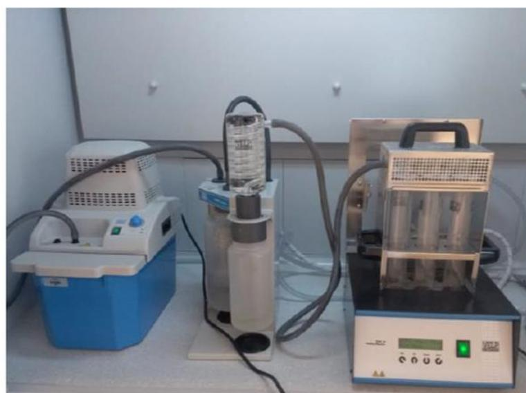
Slika 2.12 Uređaj za digestiju uzorka
