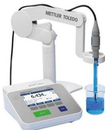
Slika 2.7 pH-metar tipa Mettler Toledo
