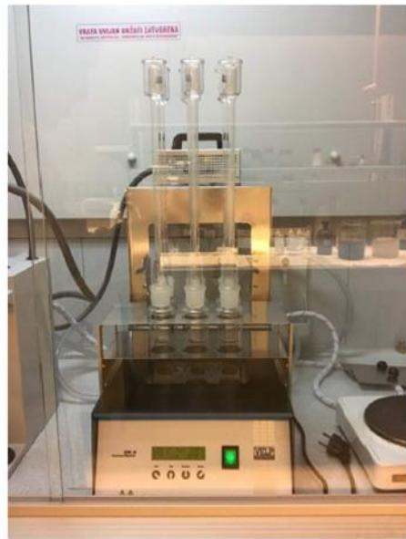
Slika 2.10 Kuhanje smjese u digestoru uz refluks
