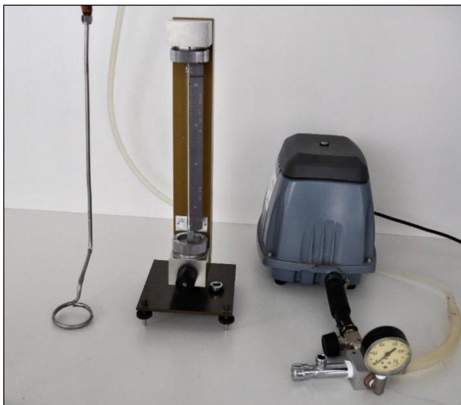
Slika 19. Aparatura za dovod zraka u sustav.
