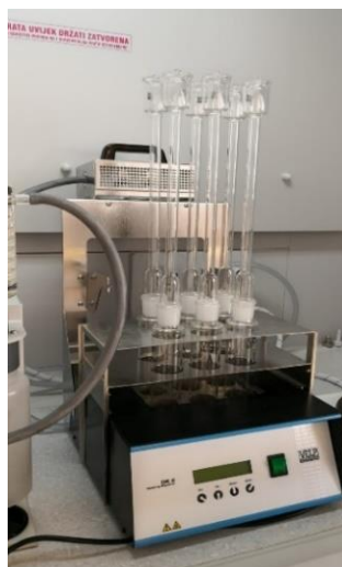
Slika 2.4. Aparatura za određivanje KPK.
