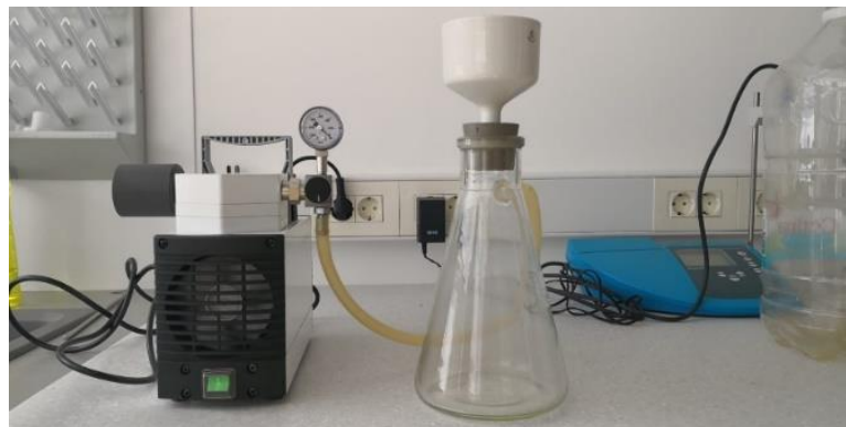
Slika 2.5. Aparatura za filtraciju.
