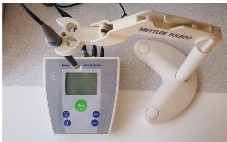
Slika 2.1. pH metar tipa Mettler Toledo korišten u ovom eksperimentu.
