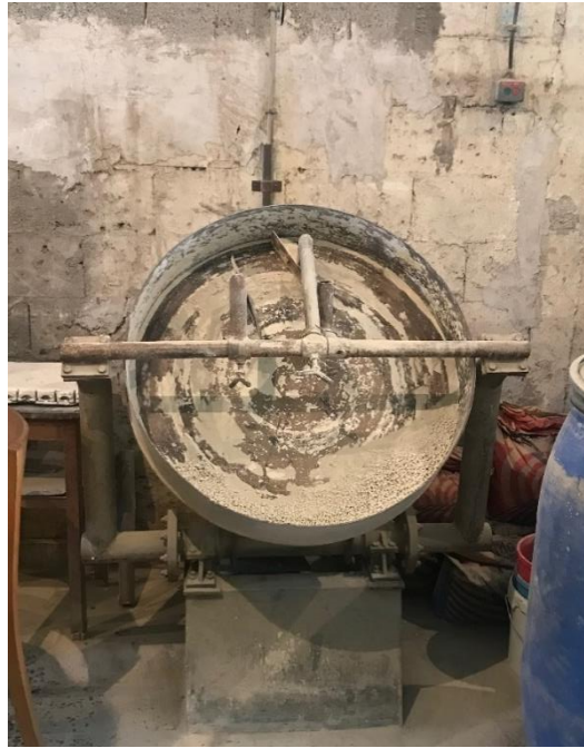
Slika 14. Granulator u poluindustrijskom postrojenju
