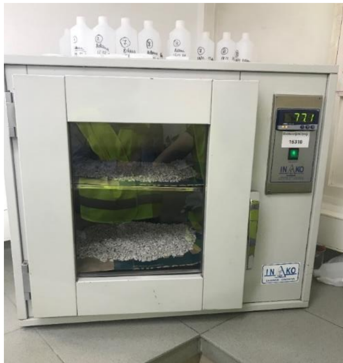
Slika 10. Sušenje sirovine u sušioniku
