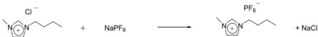
Slika 13. Prikaz sinteze 1-butil-3-metilimidazolijevog heksafluorofosfata reakcijom anionske izmjene između 1-butil-3-metilimidazolijevog klorida s Bronstedovom kiselinom NaPF 6 . 23
