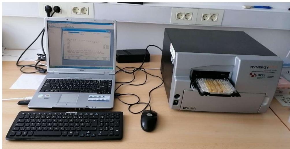
**Slika 8.** Mikrotitarski čitač koji se koristio za određivanje aktivnosti i inhibicije polifenol oksidaza
