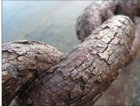
Slika 4.) Korodirani željezni lanac uslijed djelovanja morske vode
