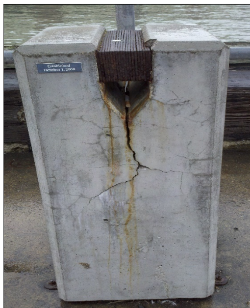
Slika 6.) Korodirani klin, postavljen za demonstraciju sile kojom hrđajuće željezo prilikom širenja može djelovati
